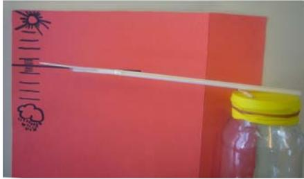
Jetzt ist das Barometer fertig. Ist der Luftdruck hoch, drückt er von außen die Ballonhaut nach unten und die Nadelspitze zeigt nach oben: Schönwetter. Lässt der Luftdruck nach, hebt sich die Ballonhaut wieder und die Nadelspitze wird sich unter den Mittelstrich senken: Regenwetter.
