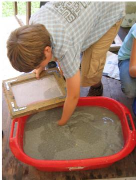
Der Faserbrei wird in die mit viel Wasser gefüllte Wanne gegossen. Die Pulpe muss immer wieder umgerührt werden, da sich der Brei schnell am Boden absetzt.
