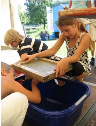
Die Form wird langsam in eine waagrechte Lage gebracht. Sie sollte nun etwa 2 bis 3 cm unter der Wasseroberfläche liegen. Der Schöpfrahmen wird angehoben und langsam aus der Pulpe gezogen. Der Rahmen wird leicht nach rechts, links, vorne und hinten geneigt, damit die Fasern verfilzen und zusammenhalten. Mit einem Schwamm wird Wasser, das von der Unterseite tropft, abgesaugt.
